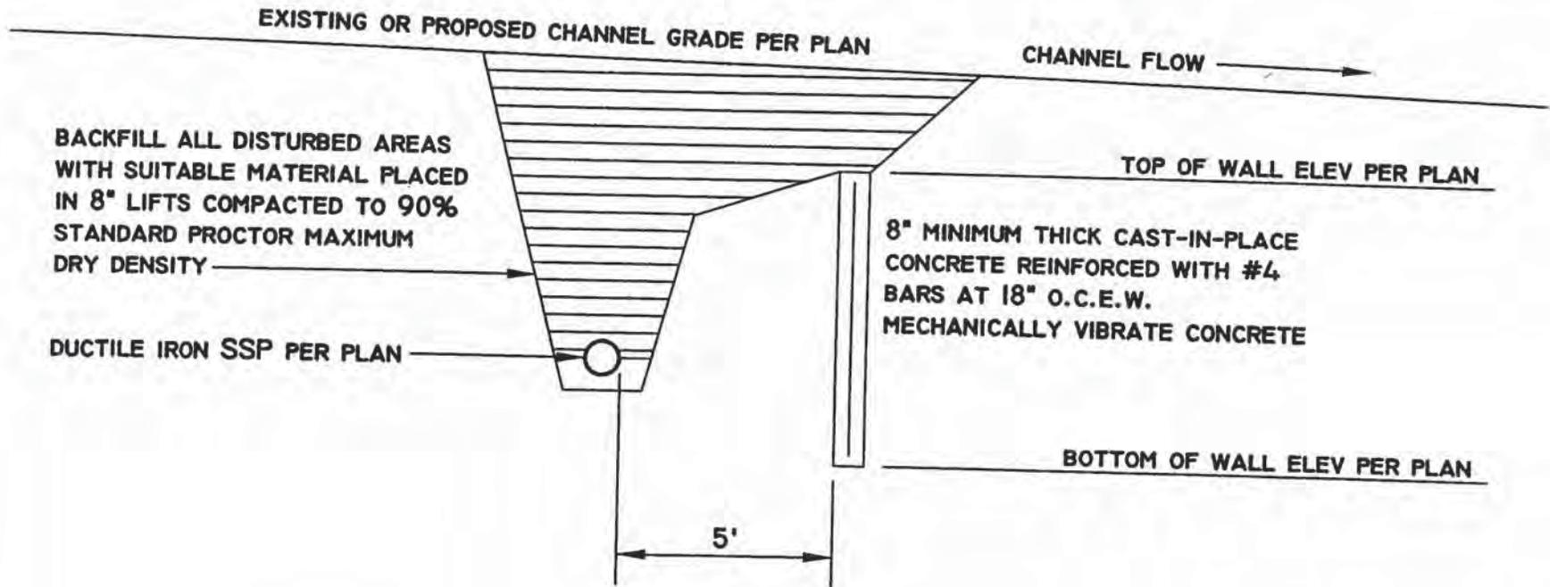
EROSION CUTOFF WALL TYPICAL SECTION
