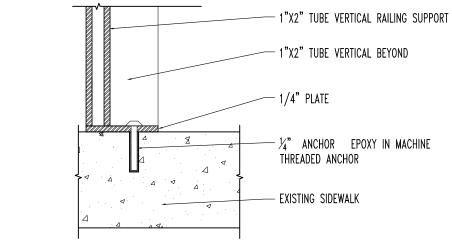
CONNECTION DETAIL - SECTION Scale: 3'' = 1'-0''
